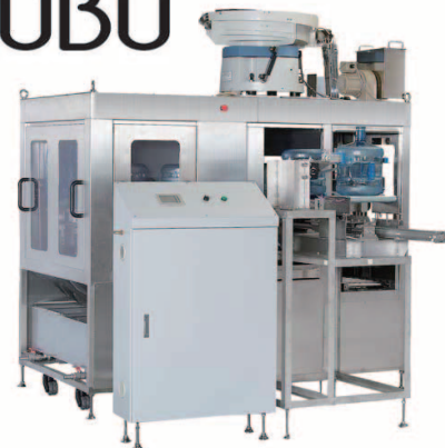
ウォーターロボ200 240本/3ガロン/時 全自動ガロン用リンサー/フィルター/キャッパー
