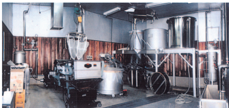
コンパクト原料処理施工例 1600kg仕込 W7050m/m × D6300m/m × H3900m/m
